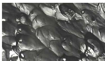
Рис. 4. Фрактограммы поверхности разрушения металла после испытаний на циклический изгиб при 565 °С:
